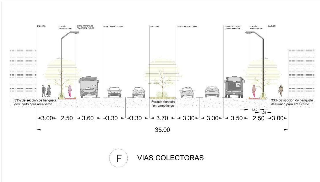
Ilustración 10 Sección vial para vialidades colectoras
